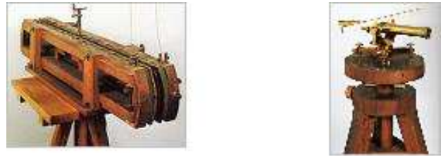
Figura 9. Bobina receptora (izquierda). Anteojo usado para ver el movimiento de la aguja.
